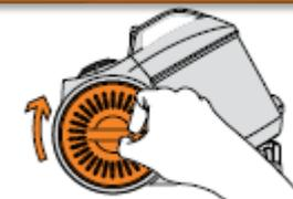
Drehen Sie die Abdeckung, um sie zu verriegeln.
