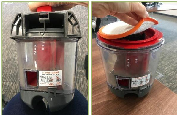
Drehen Sie den Staubbehälterdeckel, um ihn abzunehmen, und heben Sie ihn an, um den Filter herauszunehmen.
