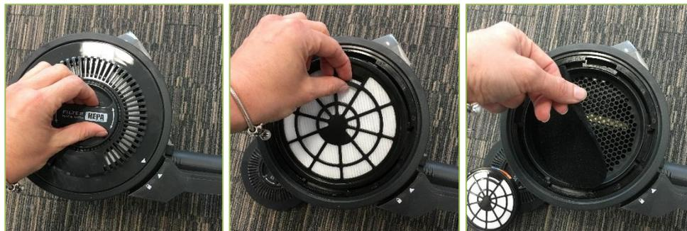
Drehen Sie die Abdeckung gegen den Uhrzeigersinn, um sie zu entriegeln. Nehmen Sie den Haustiergeruchsfilter und den Nachfilter des Motors heraus.
