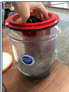
Drehen Sie den Deckel, um ihn abzunehmen, und klopfen Sie den Separator sowie den Deckel über einem Abfalleimer aus, um Schmutz zu entfernen.
