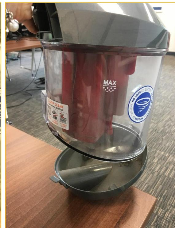
Halten Sie den Staubbehälter über den Abfalleimer. Drücken Sie den Entriegelungsclip an der Unterseite des Staubbehälters, die Entleerungsklappe öffnet sich, sodass Schmutz und Staub herausfallen können.
