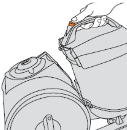
Drücken Sie die Entriegelungstaste des Staubbehälters. Ziehen Sie den Staubbehälter aus dem Gerät heraus.
