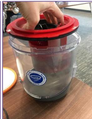
Drehen Sie den Deckel, um ihn abzunehmen, und klopfen Sie den Separator sowie den Deckel über einem Abfalleimer aus, um Schmutz zu entfernen.
